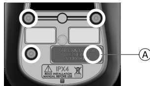
Fig. 4-2 Schraubenpositionen an der Manschettenhalterung REM060, REM1xx und REM2xx. Vierte Schraube A unter dem Etikett.
