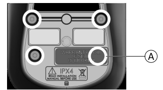
Fig. 4-2 Localización de los tornillos en los fijadores de los modelos REM060, REM1xx y REM2xx. Cuarto tornillo A debajo de la etiqueta.
