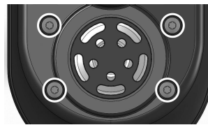
Fig. 4-1 Localización de los tornillos en el fijador del modelo REM050
