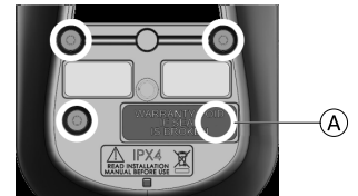
Fig. 4-2 Emplacement des vis du mécanisme de retenue du soufflet d'étanchéité sur REM060, REM1xx and REM2xx. Quatre vis A sous l'étiquette.
