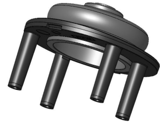
Fig. 6-1 Fole encaixado no retentor do fole
