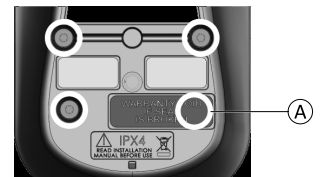
Fig. 4-2 Localizações dos parafusos do retentor do fole REM060, REM1xx e REM2xx. O quarto parafuso A encontra-se debaixo do etiqueta.
