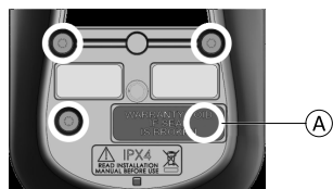
Fig. 4-2 Skruvarnas positioner på damaskhållaren på REM060, REM1xx och REM2xx. Den fjärde skruven A sitter under etiketten.
