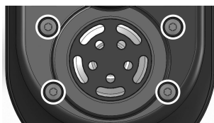
Fig. 4-1 Skruvarnas positioner på damaskhållaren på REM050
