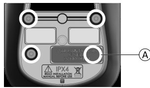
Fig. 4-2 Posizione delle viti del fermo della cuffia per REM060, REM1xx e REM2xx. Quarta vite A sotto l'etichetta.
