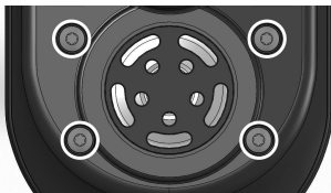
Fig. 4-1 Schraubenpositionen an der Manschettenhalterung REM050
