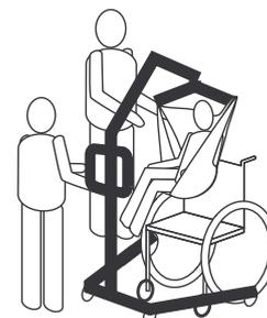
Sollevare il paziente a un'altezza sufficiente per liberare la superficie della carrozzina, in modo che il suo peso sia interamente sostenuto dal sollevatore.
