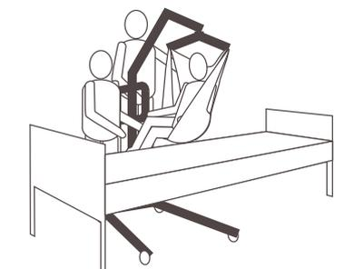
Utilizzando le maniglie dell'imbracatura, ruotare il paziente in modo che si trovi di fronte all'assistente che manovra il sollevatore.
