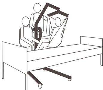
Sollevare o abbassare il sollevatore per posizionare il paziente sulla superficie fissa. Assicurarsi di sollevare o abbassare sufficientemente il paziente per liberare i lati dell'oggetto fisso.
