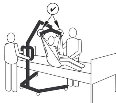
Prima di spostare il paziente, controllare nuovamente che l'imbracatura sia fissata correttamente ai ganci del bilancino. Consultare 6.2.1 *Attacco dell'imbracatura al sollevatore, pagina 21.* Se gli attacchi non sono posizionati correttamente, abbassare nuovamente il paziente sull'oggetto fisso e correggere il problema.
