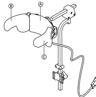
1. Attivare la scheda funzionale per la marcia avanti. Attivare il cuscinetto centrale **A** per guidare in marcia avanti.
